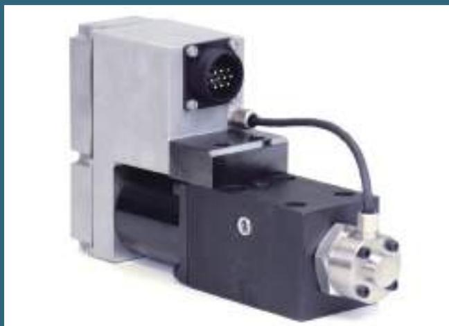
Model DAシリーズは、デュアル・ハルバツハ・マグネット・アレーによる強磁界を得て、その環状空間に差動型ボイスコイルを配置し、従来の倍以上の推力を発揮し、優れた応答性、優れた耐コンタミ性を有する油圧用流量制御弁である。
